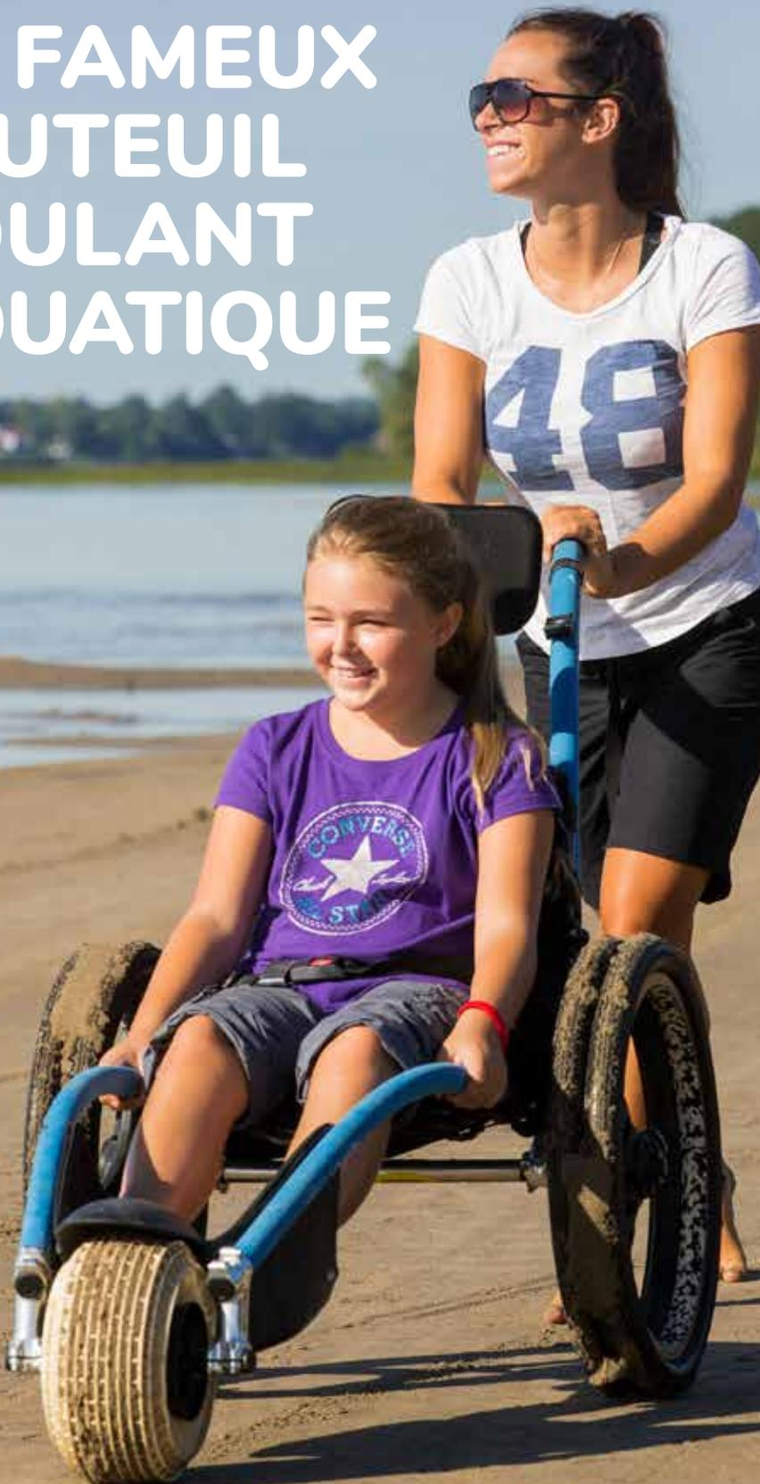
L'hippocampe est un fauteuil roulant de plage, conçu spécialement pour pouvoir se mouvoir dans le sable. Imperméable, cet équipement possède deux roues arrière et une roue avant. Les roues du fauteuil hippocampe sont amovibles : on peut ainsi avoir des roues surdimensionnées pour aller dans l'eau, des roues gonflables pour aller sur l'eau, ou des skis pour aller sur la neige.
